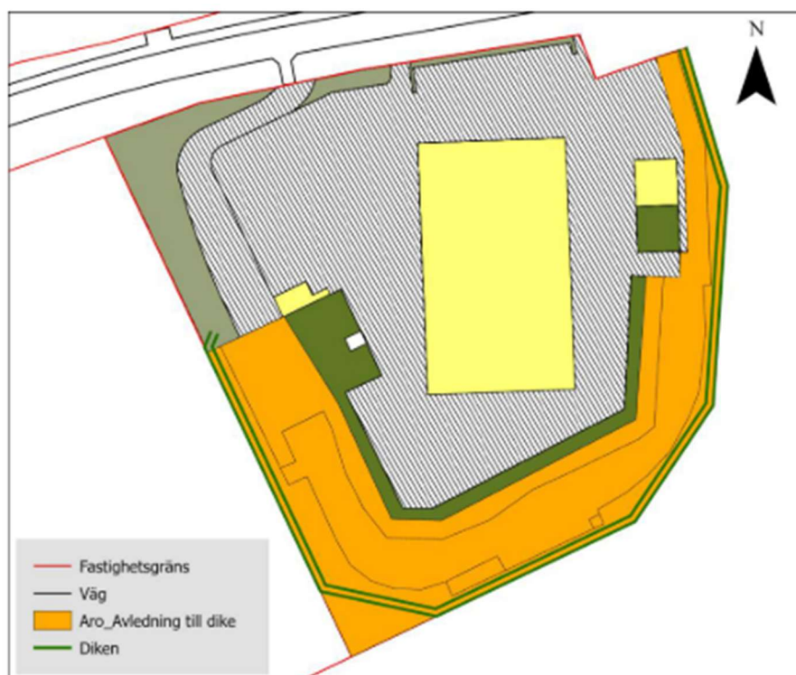
Figur 5. Konceptuell, preliminär bild över dagvattenhantering. Takdagvatten uppstår på gula och mörkgröna ytor. De mörkgröna ytorna är planerade för sedum vilket innebär att avrinning från dessa tak fördröjs och evaporerar samt evapotranspirerar. Orangea ytor är körytor för returparken som avvattnas till dike och sedan vidare till dammområdet. Grå-rastrerade ytor är kör-/och rangerytor. Dessa planeras avvattnas via brunnar och avrinna i ledningar till dagvattendammarna.
