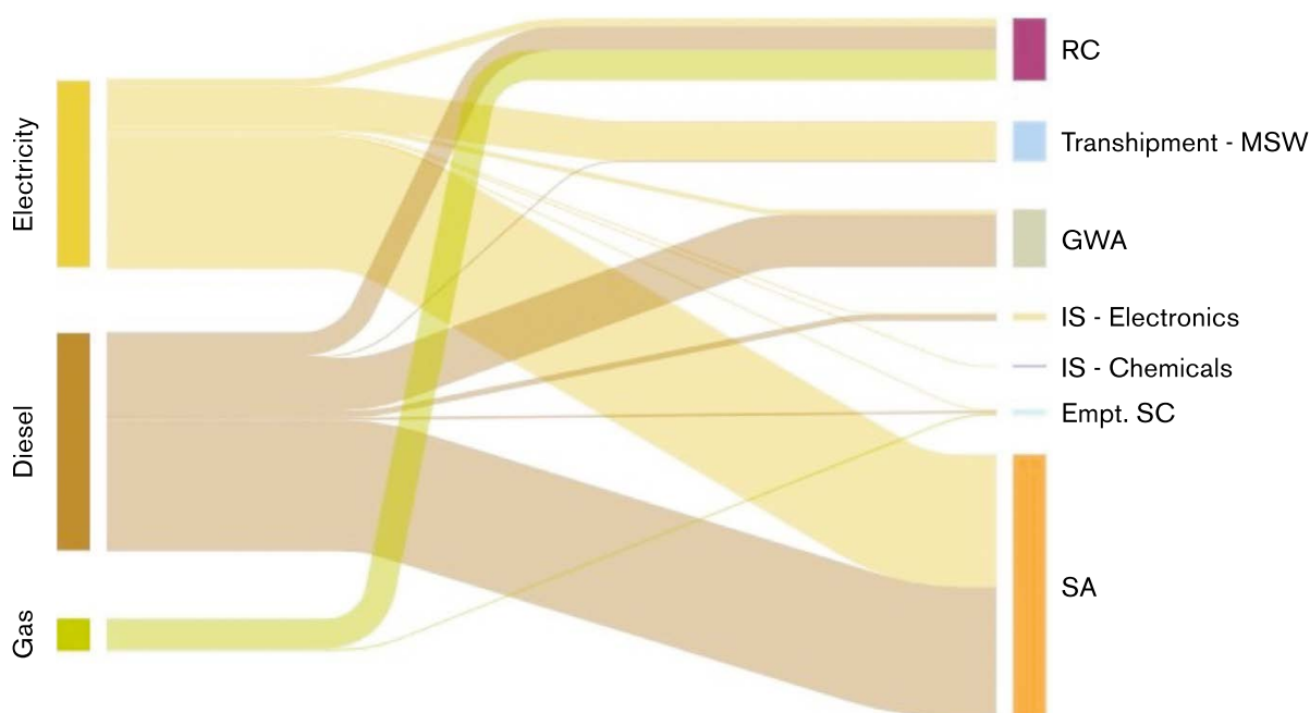
Figuren ovan är ett så kallat Sankey-diagram som illustrerar hur energiförbrukningen inom Hagby återvinningsanläggning fördelar sig mellan de olika verksamhetsdelarna.
